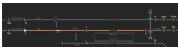
Zobrazowanie jazdy na sygnał zastępczy uzależniony przebiegowo przy uszkodzeniu kontroli położenia zwozniczy.
