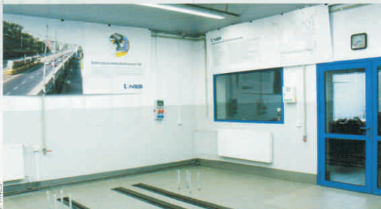
Stanowisko szyn w otulinie Tinesa zamontowane na Politechnice Poznańskiej
