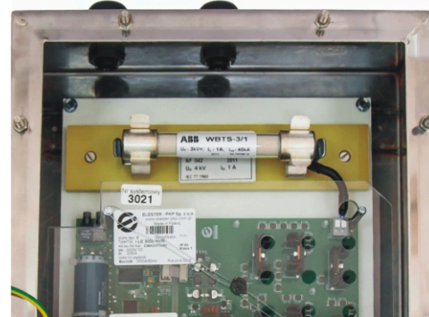
Zintegrowany z częścią pomiarową HVM bezpiecznik.
